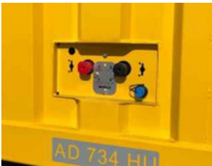
Sistema de neumático de doble circuito. Uno de servicio y otro de emergencia.
