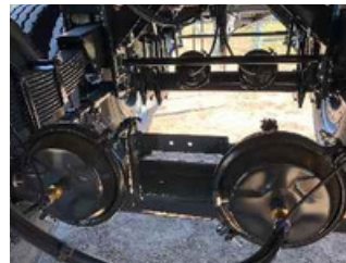
Sistema de neumático de doble circuito. Uno de servicio y otro de emergencia.
